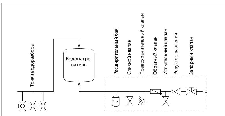
В случае превышения указанного в настоящей инструкции максимального рабочего давления воды, отсутствия предохранительного и обратного клапанов, а также при использовании не подходящих или неисправных соеди-
