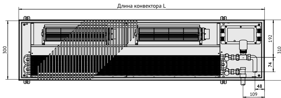
Вид сверху конвектора Qtherm НК2 310.150 с роликовой решеткой, с U-образным бортом.
