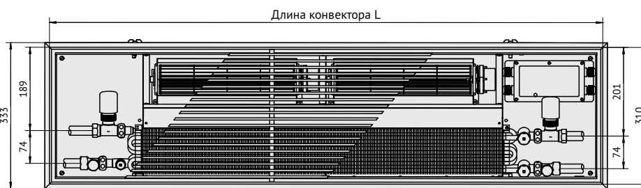
Вид сверху конвектора Qtherm НК4 310.130 с линейной решеткой, с F-образным бортом.
