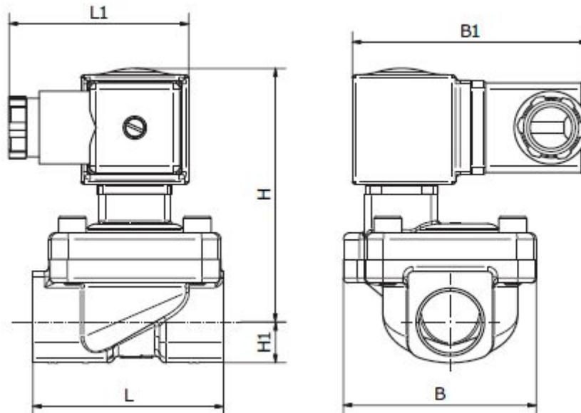
Рис. 5.2.. Габаритные и присоединительные размеры клапана типа EV220W
