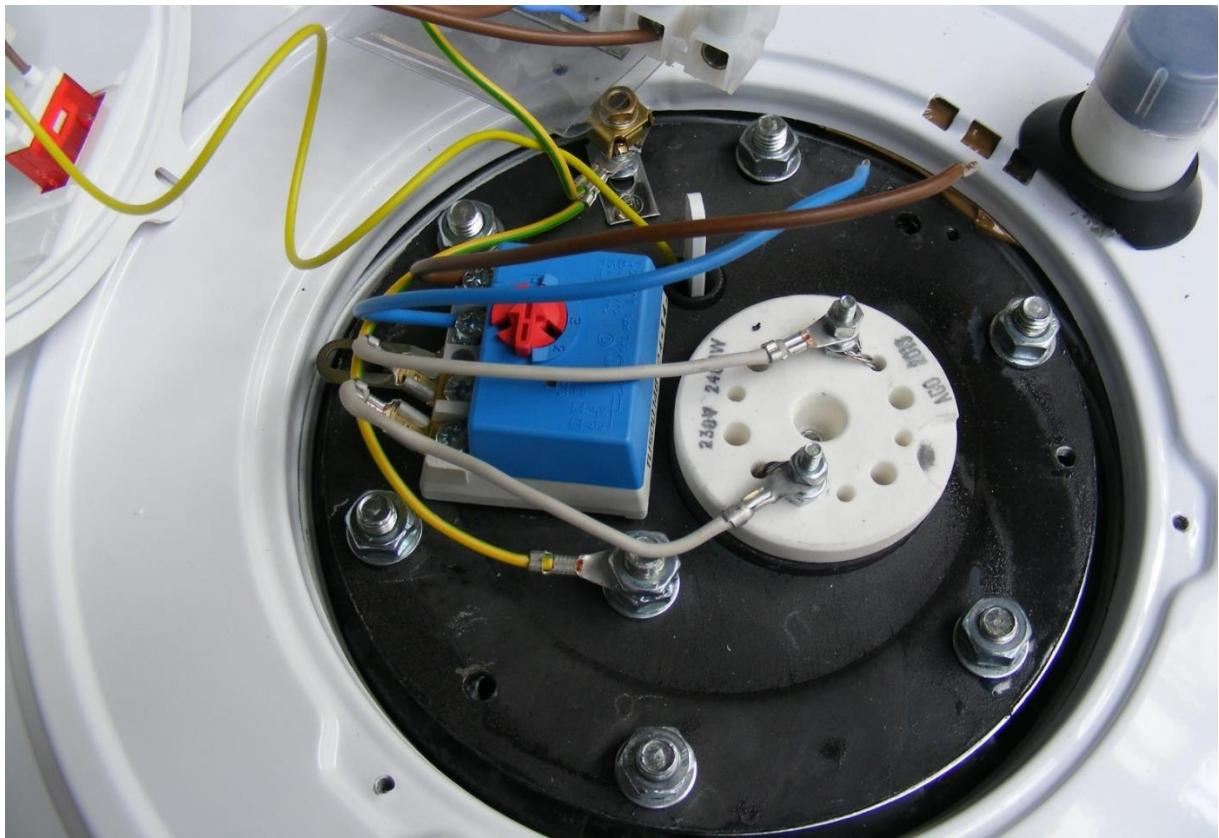
**3. С помощью винта закрепить пластины, удерживающую ТЭН.**
